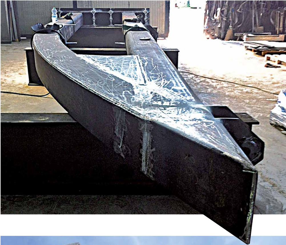
Figura 24 Realizzazione in officina dei telai metallici e relativi controlli.
