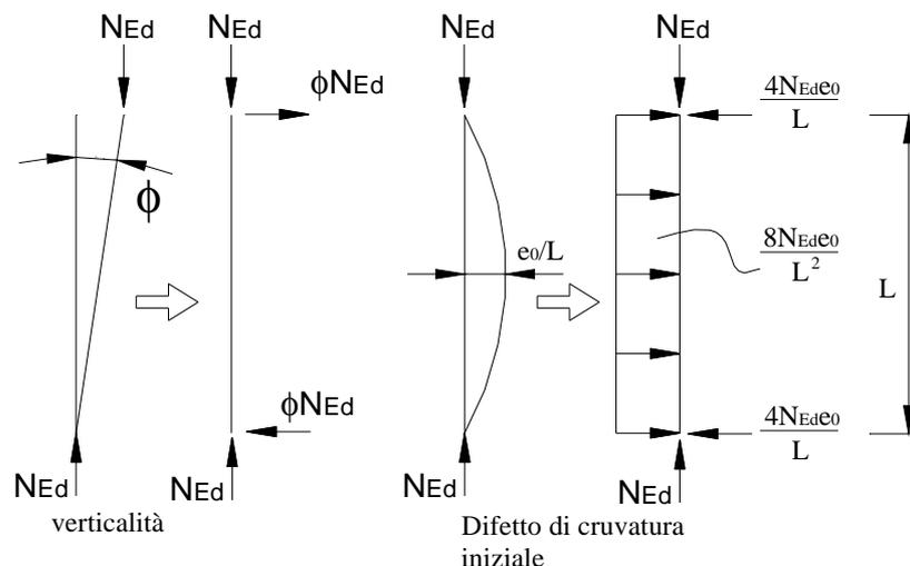
**Figura C4.2.4** Sistemi di forze equivalenti alle imperfezioni
