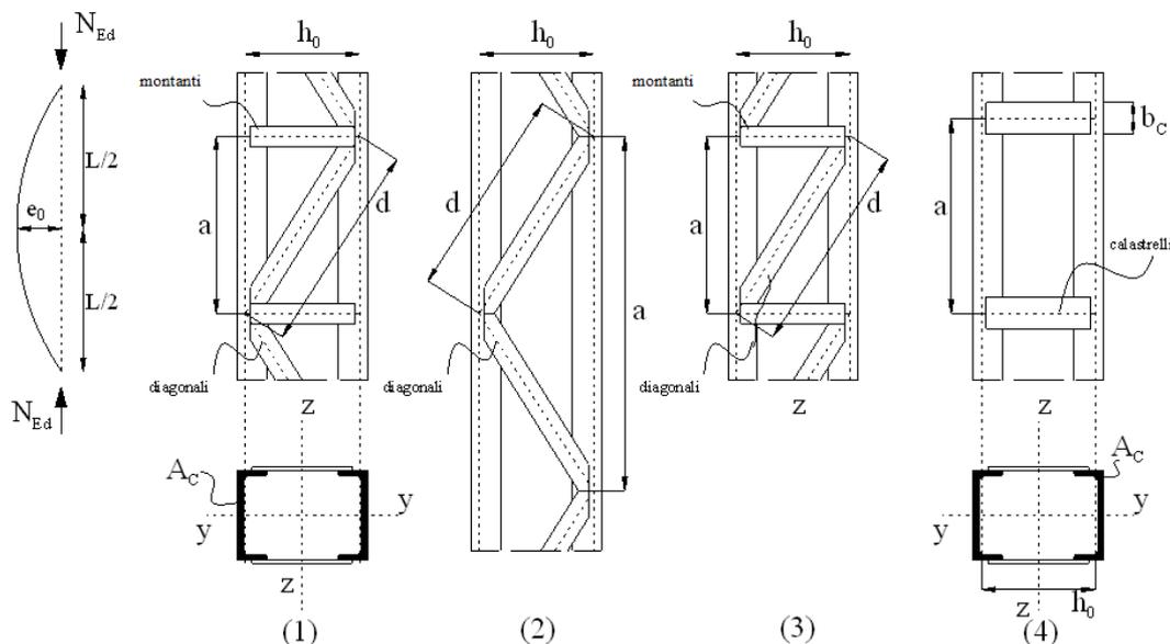
**Figura C4.2.7 - Aste composte costituite da due correnti uguali**
