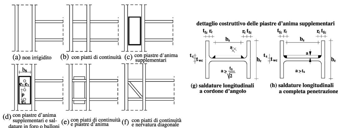
Fig. C7.5.2. Dettagli costruttivi di pannelli nodali irrigiditi.
