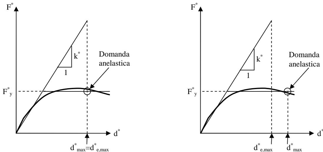
**Figura C7.3.2a** – Spostamento di riferimento per  $T > T_C$
