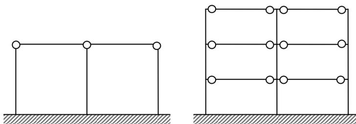
**Fig. C7.4.2.-** *Strutture a telaio con collegamenti a cerniera*
