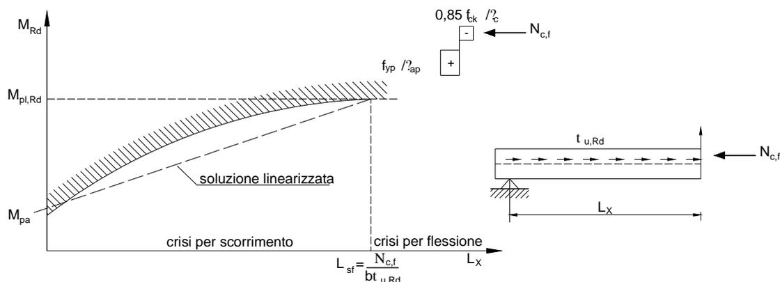
**Figura C4.3.12** Diagramma di interazione parziale calcestruzzo lamiera.
