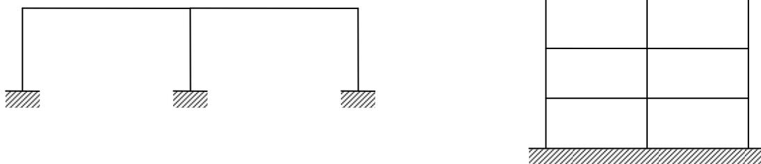
**Fig. C7.4.1.-** *Strutture a telaio con collegamenti monolitici*
