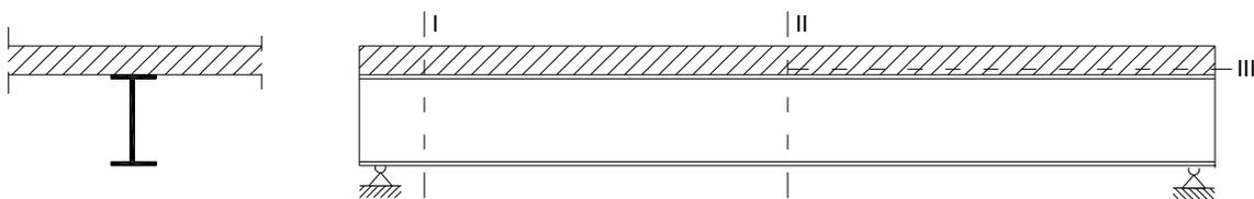
**Figura C4.3.5** – Trave d'acciaio con soletta collaborante
