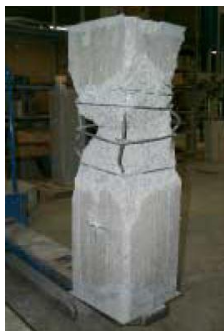
Concio di pilastro senza confinamento efficace: danneggiamento grave dopo pochi cicli
