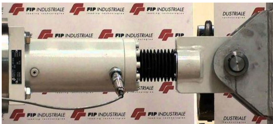
Dissipatore viscoso durante le prove di accettazione (per gentile concessione di FIP MEC srl)
